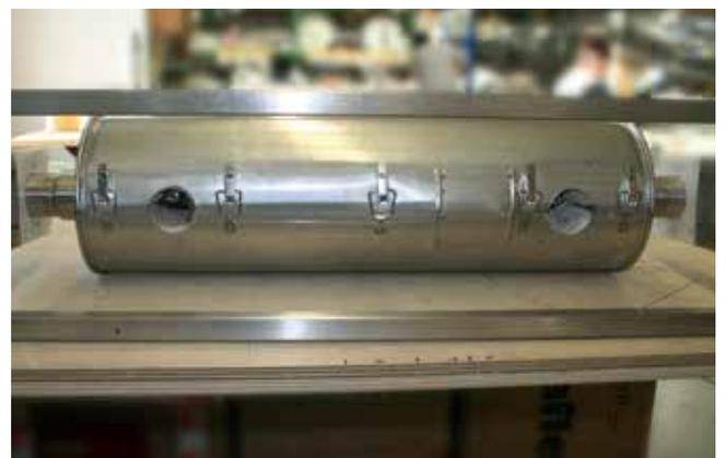
带金属板外护套的加热套
