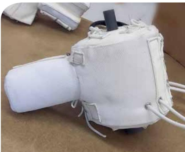
石英加热套，用于实验反应堆
