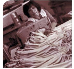
手动操作: eltherm制造的加热电缆, 连同客户要求相应的绝缘材料, 会被缝到加热套或加热垫的底布上。
