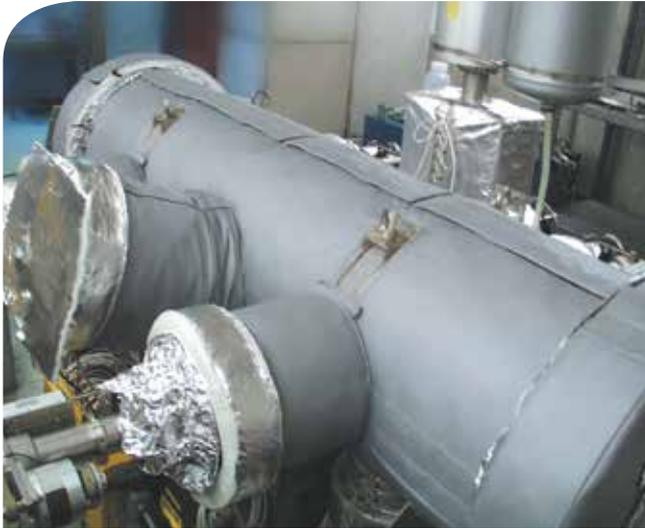
加热套，使用玻纤绝缘层电阻型加热电缆，用于真空室
