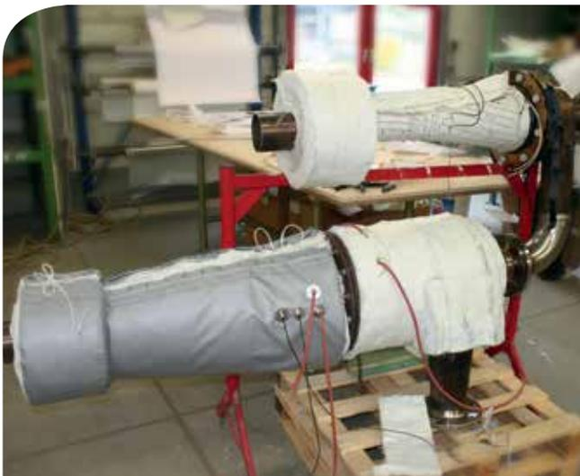
加热套组，用于旋风除尘器
